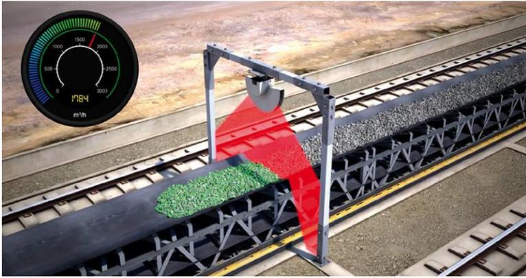
Так же и форма насыпного навала на ленте, определяемая среди прочего пористостью материала, оказывает влияние на расчёт фактического объёма перевалки на конвейере. А при эксплуатации линии в уличных условиях требуется учитывать погодные факторы (влажность воздуха, дождь, снег, туман),
